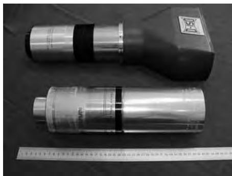
Plus de 120 objectifs de projection sont conservés dans un but d'études et de recherches. Ici, deux modèles D-150 pour films 70mm (1966).
