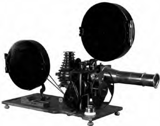
Projecteur d'enseignement 35mm Pathé-Frères (1920). Facile à utiliser, ce projecteur manuel ajoute à l'image animée la projection de vues fixes par diapositives en verre, grâce à une lanterne pivotante. Pour des raisons de sécurité la lampe à incandescence est de faible puissance. Coll. Verscheure.
