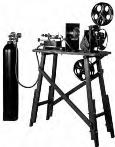
Reconstitution réalisée à l'aide d'éléments originaux à l'exception du chevalet dont on n'a retrouvé qu'un seul exemplaire en mauvais état. Ce cinématographe Lumière de projection, en état de marche, porte le n° de série 26 et fut fabriqué par Jules Carpentier à Paris. La source de lumière est du type Molteni. Coll. Verscheure
